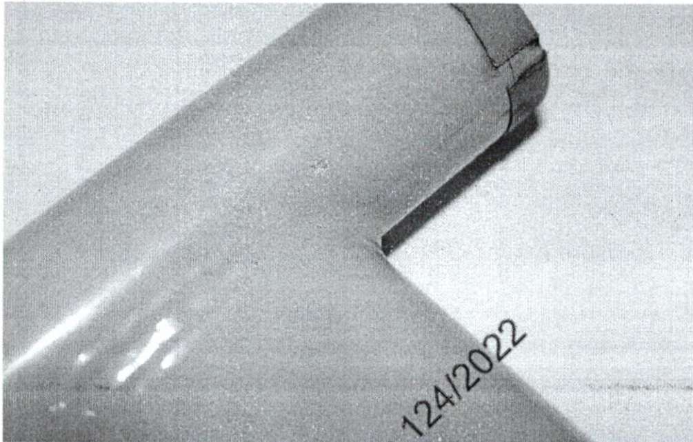
Amostra após 3000 horas de exposição.
