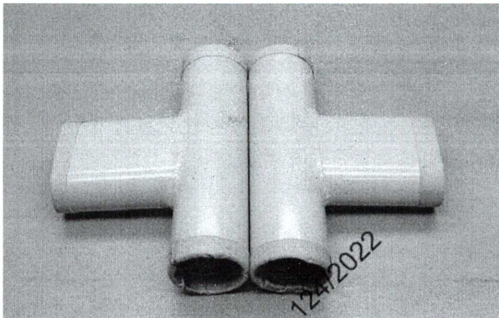
Amostra após 1512 horas de exposição.
