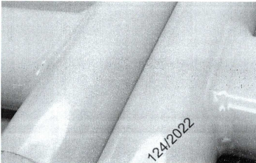
Amostra após 1512h de ensaio. Detalhe da superfície.
